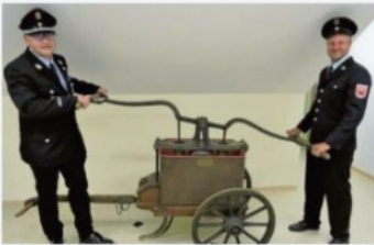
Die handbetriebene Saug-Druckspritze von 1897, testen* Kommandant Anton Gutjahr (links) und Schmirner Dornenk Brendle.
